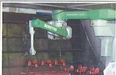
ロボットで塗装を行います。
