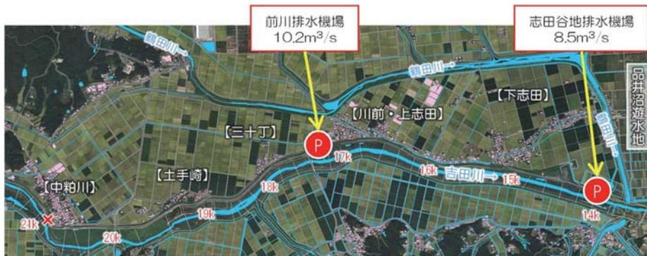
図 4-7 既存排水機場の確実な稼動 (対策2) イメージ
