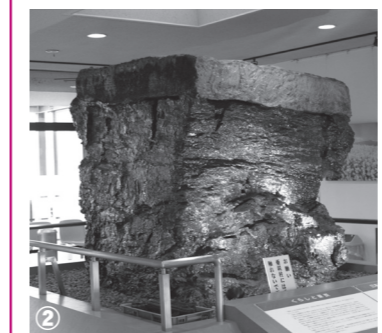
▲①亜炭産業が隆盛だったころの貴重な展示品の数々。②昭和56年、三本木地域伊賀地区から採取した残炭柱。幅1.8m、高さ1.9m、奥行き2.0m、重さ約10t、日本一大きい亜炭柱。
