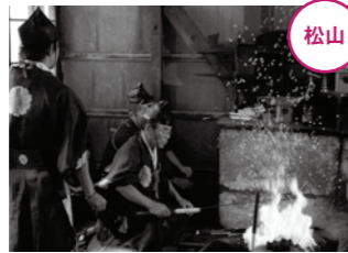
刀のもとになる玉鋼を約1,200度まで熱します。
