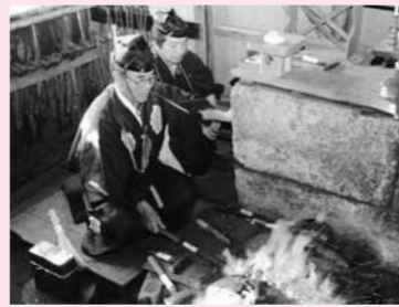
ふいごで風を送り込み日本刀となる玉鋼を真っ赤になるまで熱します
