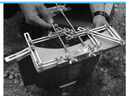
技能グランプリで審査員の好評を得た、瓦を合わせるための自作の定規「くせがね」。瓦職人は、仕事はかどるよう「治具」と呼ばれる道具を自ら作り出します。
