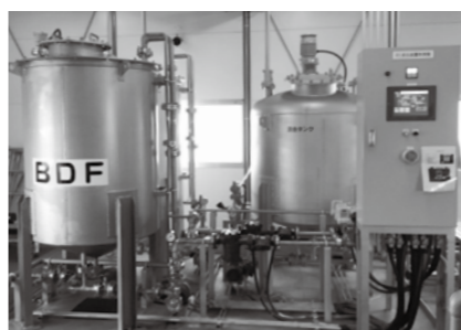
▲BDFを生成する装置。廃食用油200ℓあたり160ℓのBDFが生成できます。
