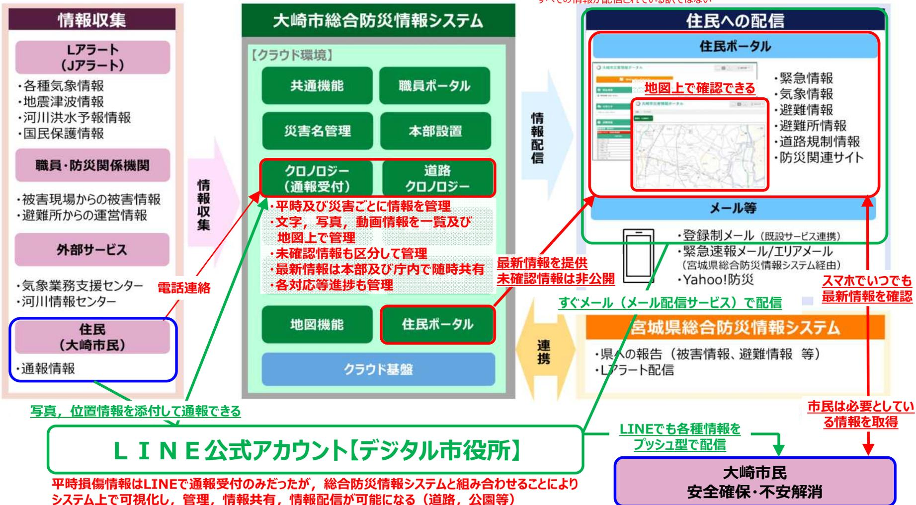
平時損傷情報はLINEで通報受付のみだったが、総合防災情報システムと組み合わせることによりシステム上で可視化し、管理、情報共有、情報配信が可能になる（道路、公園等）
