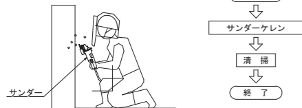
遊離石灰除去の施工フロー
